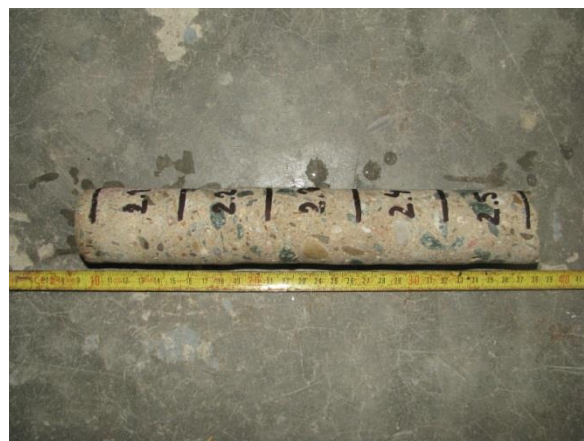
Foto 6.1.4 Laboratorní foto vzorku V2 s vyznačenými polohami zkušebních těles před zakončováním
