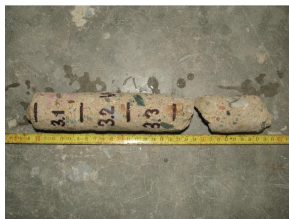
Foto 6.1.6 Laboratorní foto vzorku V3 s vyznačenými polohami zkušebních těles před zakončováním
