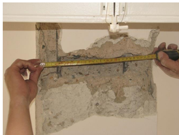
Foto 6.3.5.2 Detail měření vzdáleností jednotlivých výztuží v provedené sondě s označením S4
