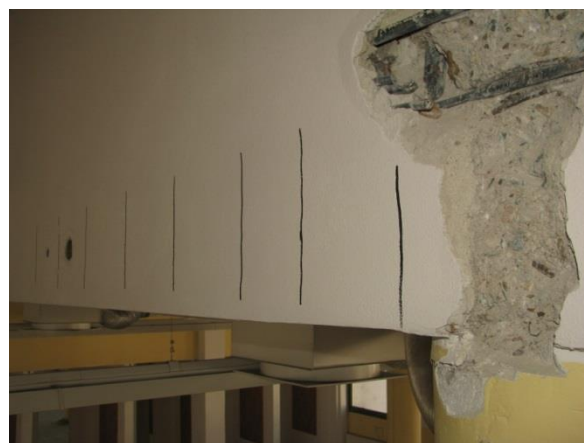
Foto 6.3.4.2 Měření vzdáleností třmínek průvlaku
