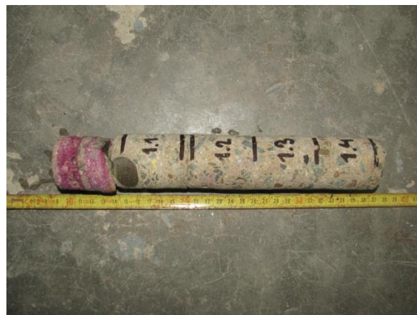
Foto 6.1.2 Laboratorní foto vzorku V1 s vyznačenými polohami zkušebních těles před zakončováním
