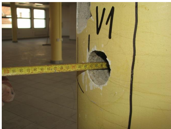
Foto 6.1.1 Pohled na odběrové místo jádrového vývrtu V1 provedeného z nosného sloupu
