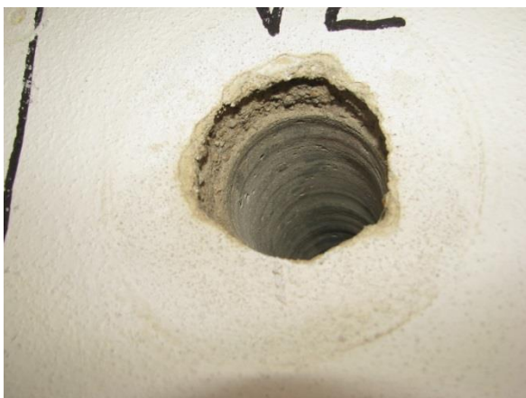
Foto 6.1.3 Pohled na odběrové místo jádrového vývrtu V2 provedeného ze stropního průvlaku
